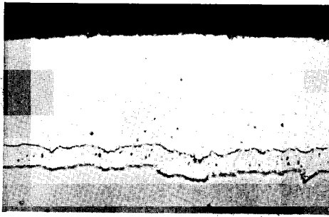
a Zinkbadtemperatur: 440° Tauchzeit: 4 s
