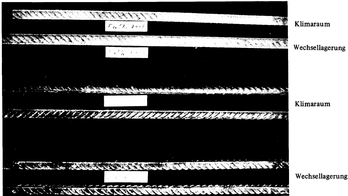
Bild 6: Übersicht über das Aussehen des verzinkten und unverzinkten Stahles A 1 nach 2jähriger Lagerung im Klimaraum bzw. Behandlung in der Wechsellagerung, Portlandzement-Beton.
