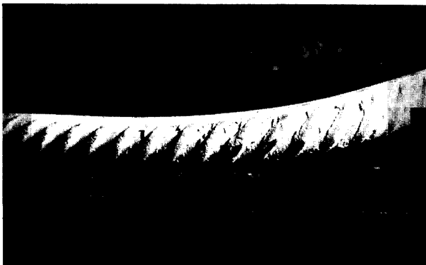
Bild 16: Feuerverzinkter Rippenstahl ( B_1 ) nach dem Rückbiegeversuch, Krümmungsaußenseite.
