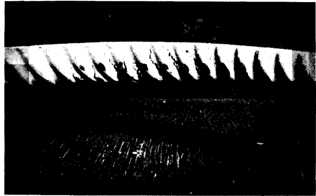
Bild 17: Feuerverzinkter Rippenstahl ( B_1 ) nach dem Rückbiegeversuch, Krümmungsinseite.
