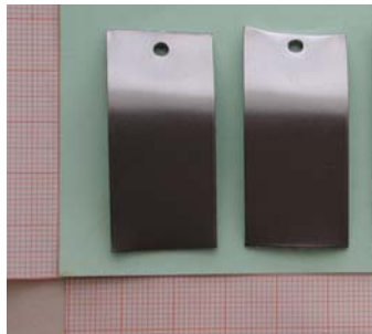
Abb. 76: Proben (1 x 50 x 20 mm) des Stahls DC 0,1-A vor dem Verzinken
