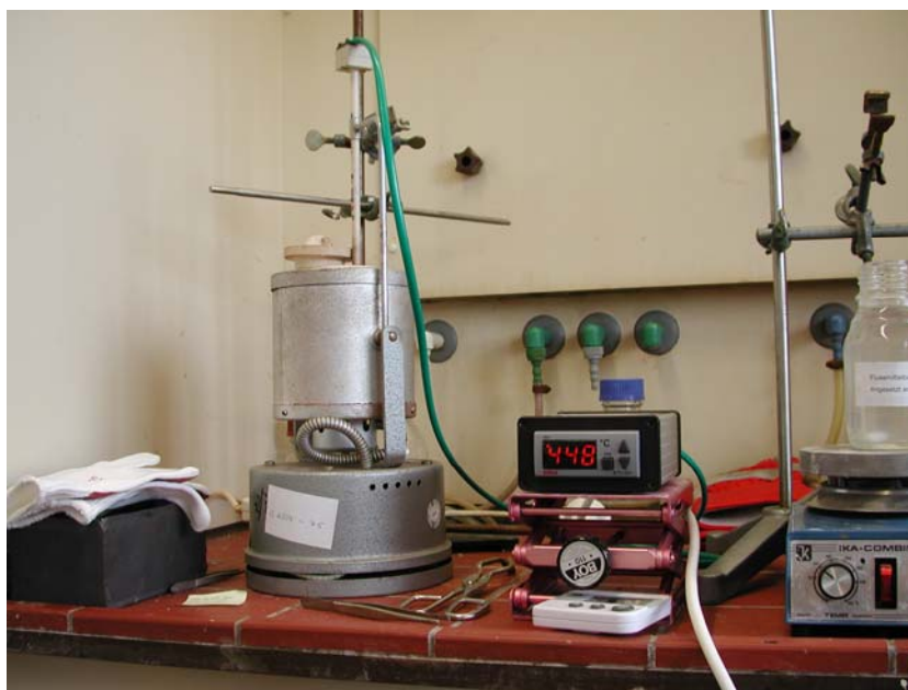
Abb. 77: Verzinkungsofen mit Temperatursteuerung
