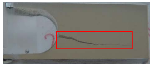
Abb. 62: Querschliff, Schmelze S5d (0,9 % Sn, 0,08 % Bi, 0,05 % Al), Flussmittel K1, v_T = 0,05 \text{ mm/s} , Risslänge: 15,1 mm
