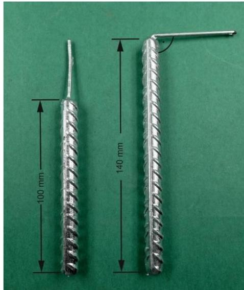
**Bild 110: Betonstahlvarianten: links für die Herstellung von Frischbetonproben, rechts für die Herstellung von Mörtelprismen**
