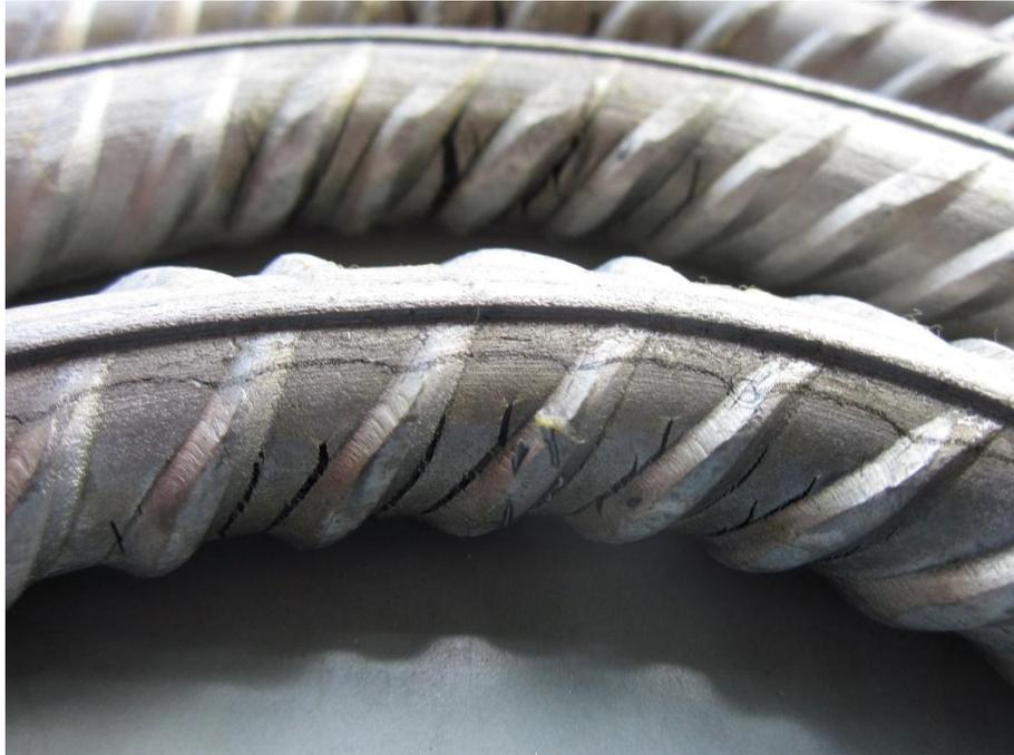
**Bild 78:** QT 16, 60/90, Rückbiegen  $\geq 20^\circ$ , klaffende, vom Rippenfuß in die Zwischenfläche verlaufende Risse
