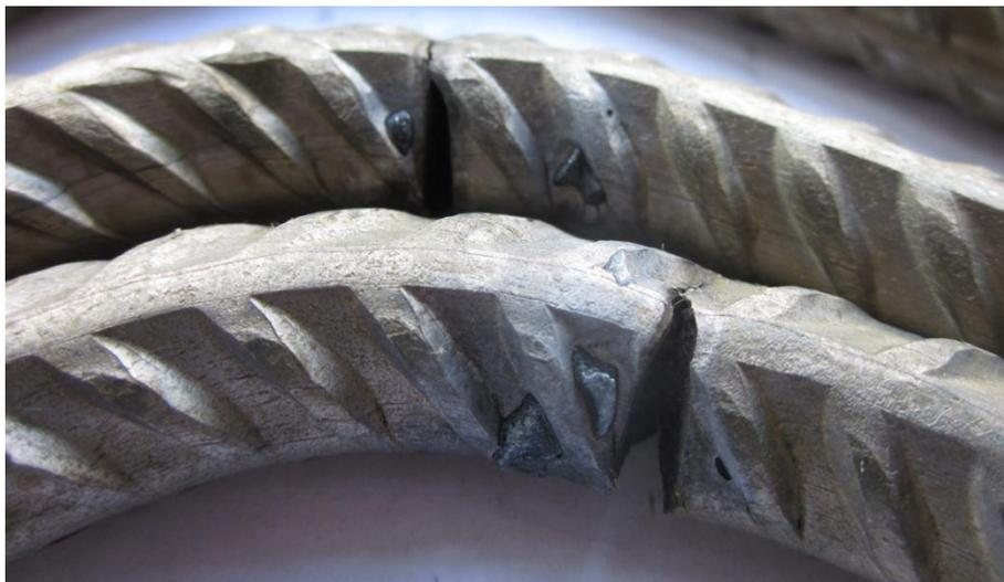
**Bild 69:** Sprödbrüche bei Werkstoff WR 14 ( $d_{Br} = 50$  mm, Winkel 90°) nach Rückbiegen  $\geq 20^\circ$ , Biegezone entzinkt
