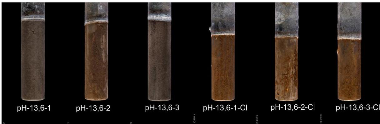
**Bild 128:** Glatte verzinkte Stähle aus Lösungsversuch mit pH 13,6 chloridfrei (links) und chloridhaltig (rechts)
