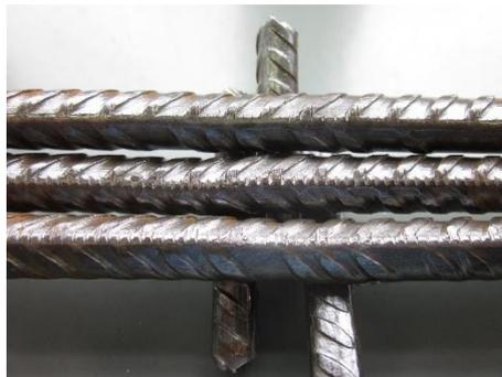
**Bild 88:** Probenoberfläche nach dem vollständigen Zurückbiegen (dBr = 40 mm, a = 0 mm, Biegewinkel = 90°) (FWB); Riefen aus dem Herstellprozess der Betonstahlmatte (keine Risse!)
