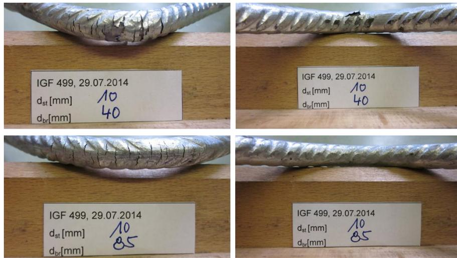
**Bild 59:** KR 10 Beschädigungen der Zinkschicht in Abhängigkeit vom Biegerollendurchmesser auf der Biegezugseite außen (links) und der Biegedruckseite innen (rechts)
