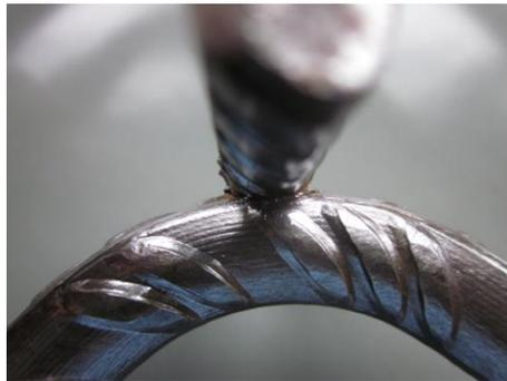
**Bild 87:** Schweißstelle nach dem Biegen um 90°
