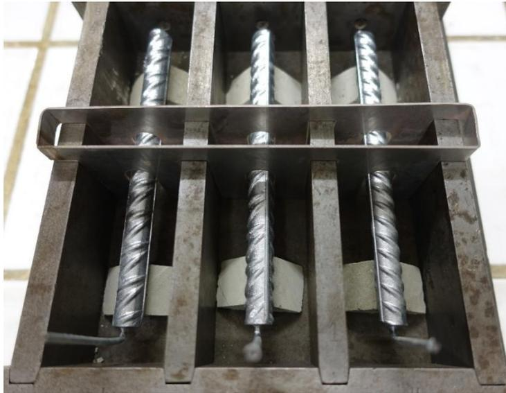
**Bild 113: Schalungsaufbau für die Herstellung der pigmentierten Mörtelprismen**
