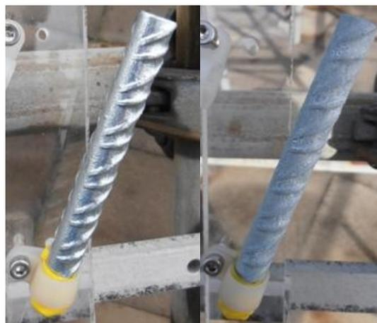
**Bild 145: Verzinkter Betonstahl links: Ausgangszustand metallisch blank, rechts: nach 4-wöchiger Freibewitterung und ausgebildeter Deckschicht**
