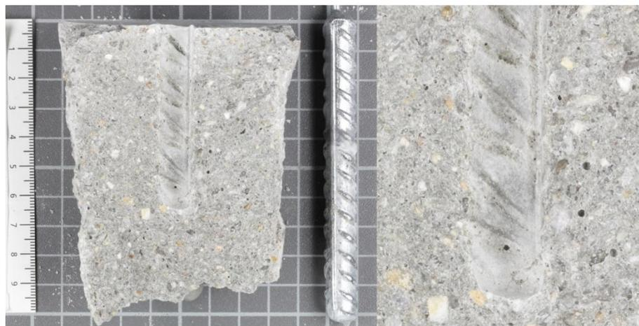
**Bild 153: Gespaltene Probe mit einem verzinkten Betonstahl der mit der Beschichtung A Typ 1 der dritten Generation beschichtet wurde, keine Gefügestörung durch Wasserstoffentwicklung**
