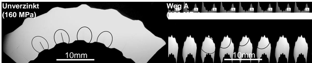
**Bild 103: Metallografische Befunde von Durchläufern, unverzinkt und verzinkt nach Verfahrensweg A (Verzinken – Biegen)**
