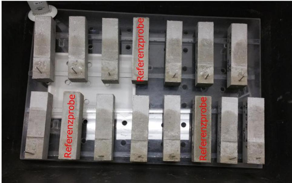
Bild 122: Karbonatisierungs- und Referenzproben in der Karbonatisierungskammer
