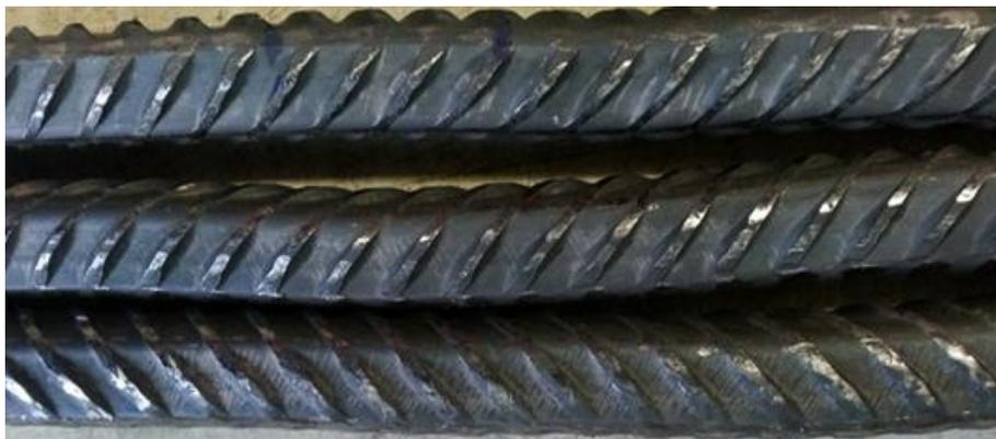
**Bild 46:** Biegezone der gerade gebogenen Proben WR 14
