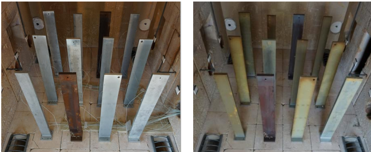
Abbildung 4: Vergleich der Proben vor (links) und nach (rechts) dem 2. Brandversuch
