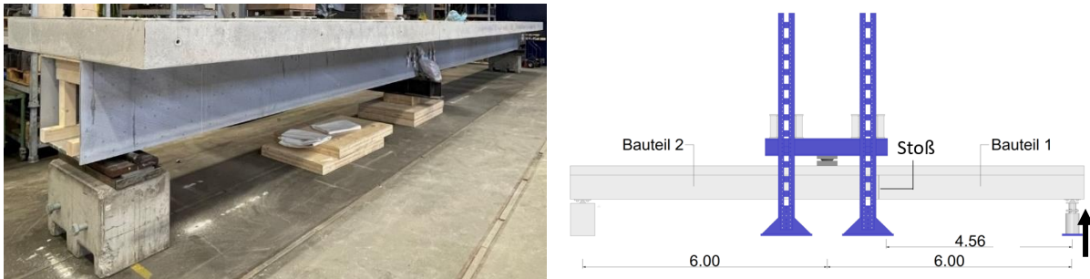
Abbildung 23: Großträger und Prüfraumen
