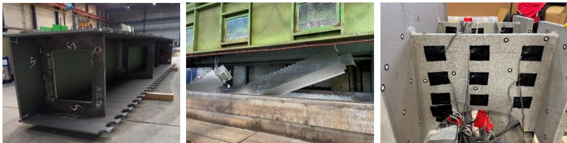
Abbildung 21: Fertigung der Stahlbauteile, Feuerverzinkung und Dehnmessstreifen
