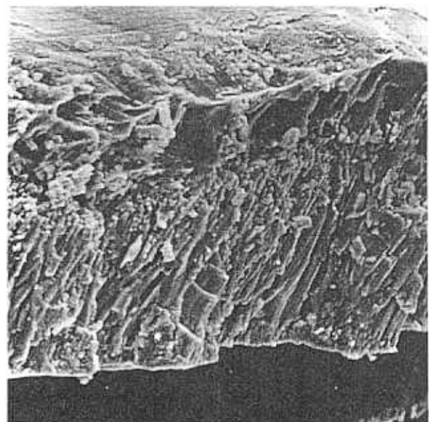
Abb. 2.2: Bruch der Zinkauflage eines verzinkten Spannstahls (1000 : 1)
