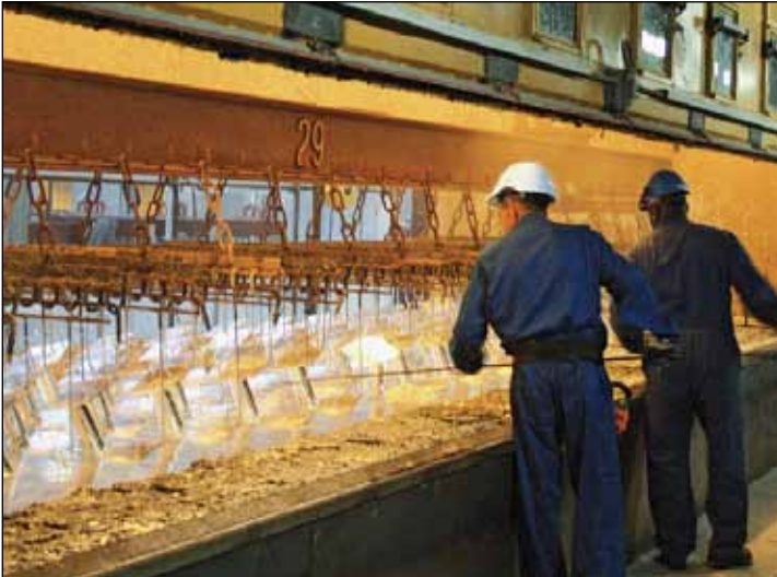
1 Zinkbad mit geöffneter Einhausung
