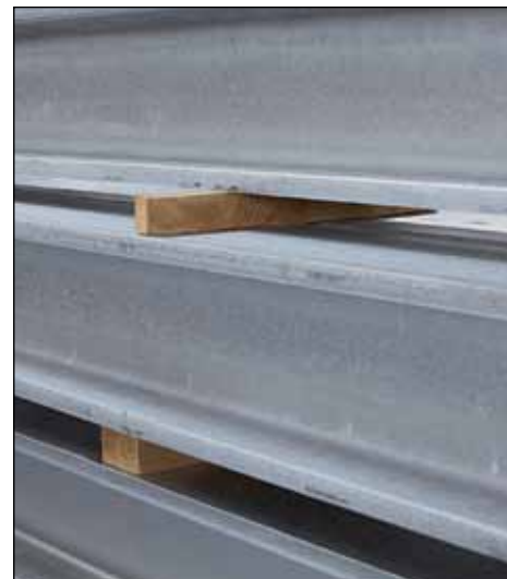
3 Durch Feuerverzinken veredelte Stahlträger
