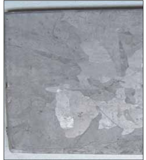
4 Wie neu: Feuerverzinktes Testblech nach 15 Jahren
