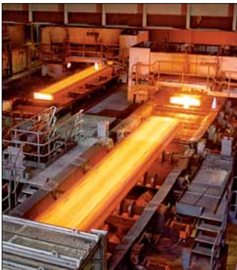
2 Herstellung von Stahlbrammen im Stranggussverfahren
