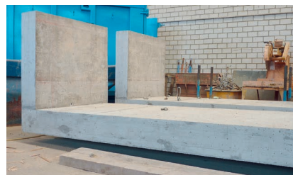
Stark unterschiedliches Verhalten völlig identischer Balkone aufgrund verschieden steifer Deckenkonstruktionen
