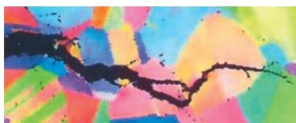
Spannungsrissskorrosion in einem Edelstahl
