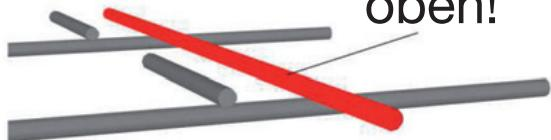
Montagehilfe MH mit Längsstäben (hier rot eingezeichnet) **nach oben** verwenden
