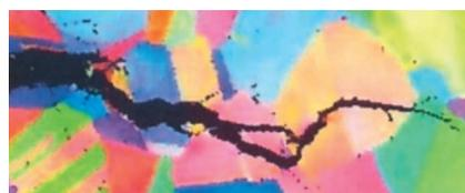
Corrosion sous tension dans un acier inoxydable
