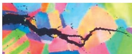
Corrosion sous tension dans un acier inoxydable
