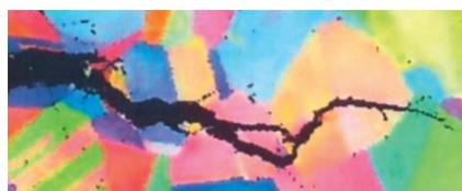
Spannungsrisskorrosion in einem Edelstahl
