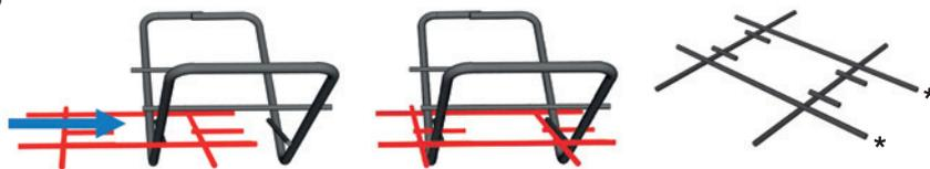
Le support de montage MH-VG-a peut être choisi de manière à assurer un positionnement en hauteur de l'élément **BASYTUBE V** correct (ceci aussi pour des gros diamètres d'armature).
