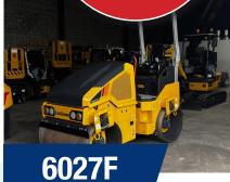
**ENGINE:** Kubota **NET POWER:** 35 hp **BASE OP WEIGHT:** 2,700 kg WIDTH: 1,200 mm
