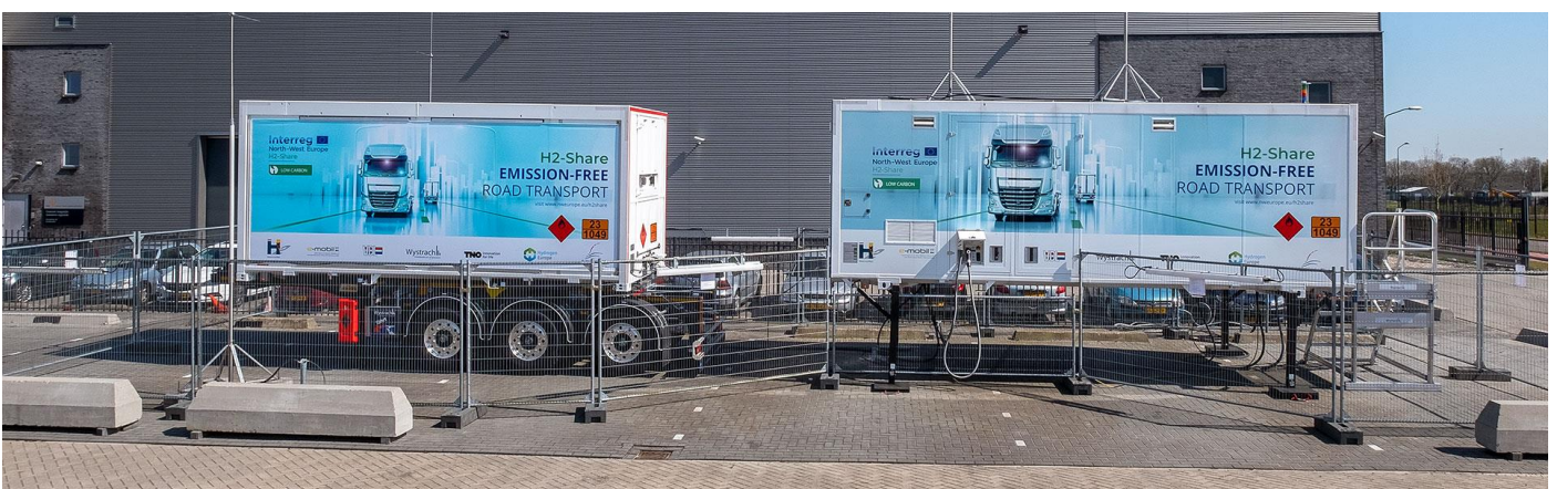
Figur 6: Eksempel på containerisert, mobil hydrogenfyllestasjon. Kilde: Wystrach 24 .
