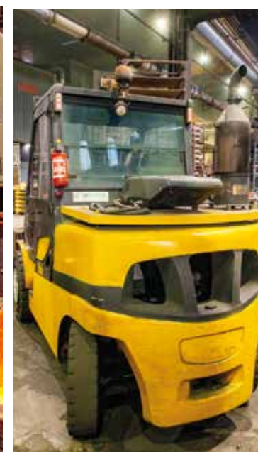
Stapler im Extrem-Einsatz in der Aurora-Hütte von WESO (l.); die Hauser-Klimaanlage sitzt hinter der Fahrerkabine (r.).
