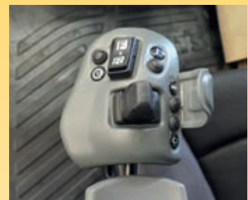
Komatsu Kurzhebel-Lenksystem (K-SLS) (optional)
