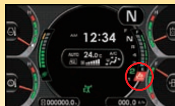
AdBlue®-Füllstandanzeige und Nachfüllhinweis
