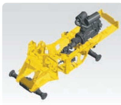
Robuster, verwindungssteifer Rahmen
