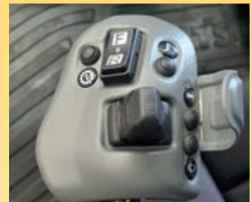
Komatsu Kurzhebel-Lenksystem (K-SLS) (optional)
