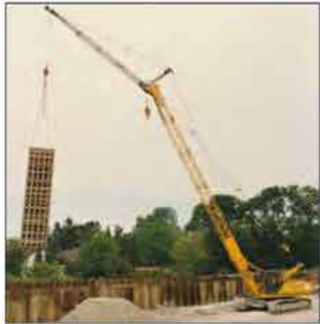
1976-1995: Raupenkrane S 1225 mit Spitzenausleger beim Heben von Verschallungstafeln
