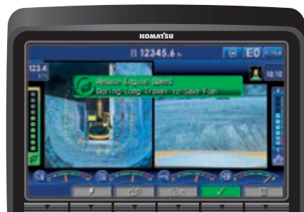
Eco-Anzeige, Eco-Hinweise und Kraftstoffanzeige
