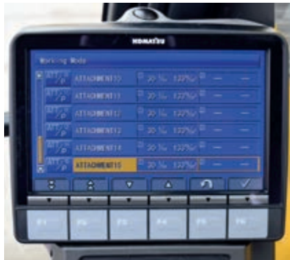
Komatsu Integrierte Anbaugerätesteuerung (KIAC) mit bis zu 15 Voreinstellungsmöglichkeiten für Ölstrom und -druck
