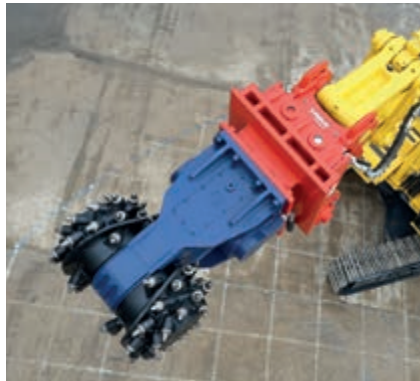
Zwei optionale Hydrauliksteuerkreise ermöglichen den Einsatz von zahlreichen Anbaugeräten
