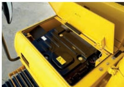
**Wechselrichter und Kondensator**
