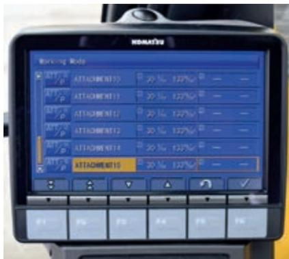
Komatsu Integrierte Anbaugerätsteuerung (KIAC) mit bis zu 15 Voreinstellungsmöglichkeiten für Ölstrom und -druck
