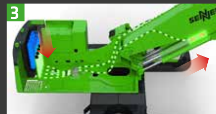
3 Nahezu konstante Kraft über den gesamten Zylinderweg unter- stützt den nächsten Hebevorgang
