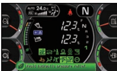
Eco-Anzeige und Eco-Hinweise mit aktiven Empfehlungen für noch kraftstoffeffizienteren Betrieb
