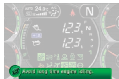
Eco-Hinweise ermöglichen Energieeinsparungen in Echtzeit
