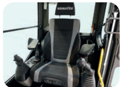
Optionaler Premium-Fahrersitz mit hochwertigen Kissen, automatischer Gewichts Anpassung, Lendenwirbelsäulenstütze, Klimaautomatik, verfügbar auch mit optionalen verstellbaren Armstützen und ergonomischen Bedienhebeln
