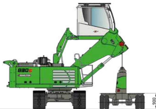
VERLADEOPTION PER 830 DEMOLITION VARIO TOOL GRUNDMASCHINE MIT UNTERWAGEN T41/380, HYDRAULISCH HOCHFABRBARE KABINE MAXCAB, 30° NEIGBAR, SEPARAT HYDRAULISCH ABLEGBARES KONTERGEWICHT
