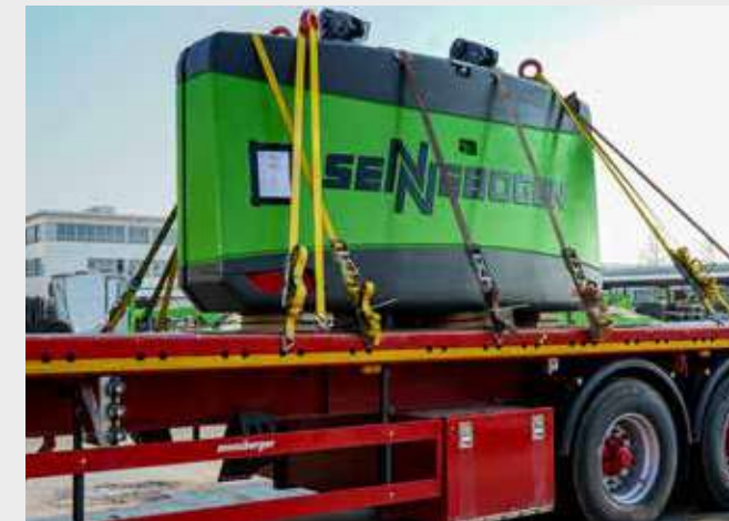
870 Demolition: Ablegbares Kontergewicht verringert Transportgewicht
