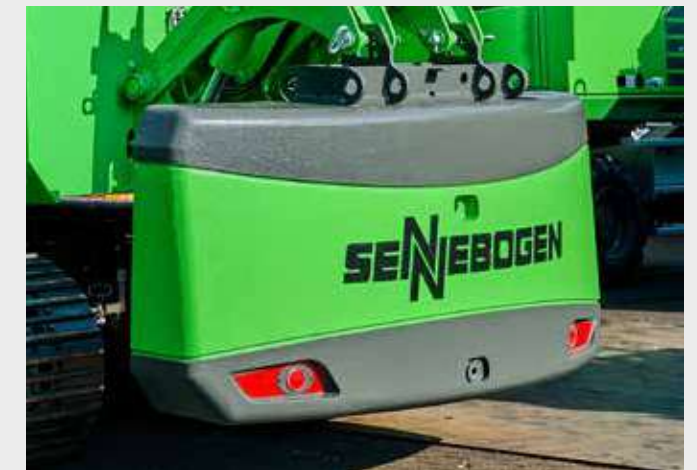
Optimal hydraulisch ablegbares Kontergewicht mit Fernsteuerung für 825 + 830 Demolition
