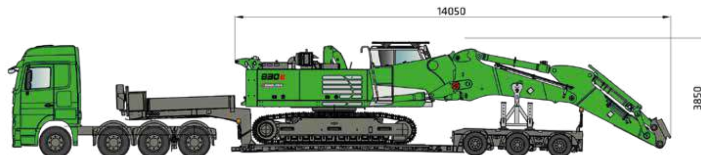
TRANSPORTOPTION GRUNDMASCHINE + EA12, INKL. LAGERBOCK, OHNE KONTERGEWICHT, EINSATZGEWICHT: 41 t
