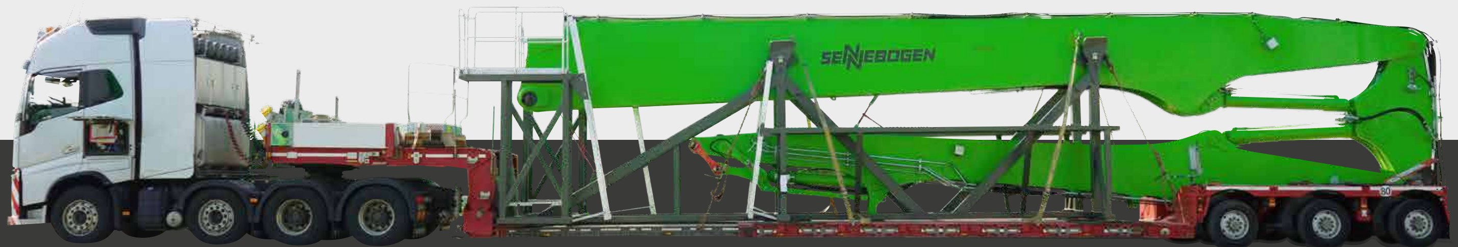
Transport der dreiteiligen Ausrüstung im Transportgestell (870 Demolition: serienmäßig, 830 Demolition: optional)
