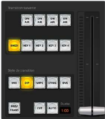
Contrôle des transitions
