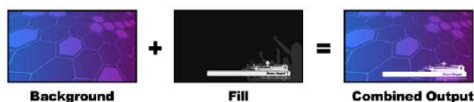
Combiner un arrière-plan aux signaux de remplissage et de découpe dans une incrustation en luminance.
