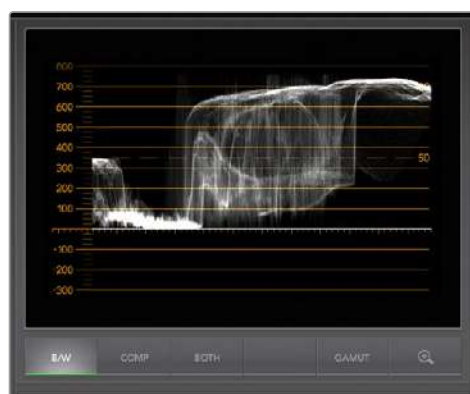
L'affichage Forme d'onde sur Windows permet de voir les affichages Luminance, Composite ou Both.
