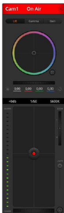
La fonction de contrôle des caméras vous permet de contrôler les caméras Blackmagic à partir de votre mélangeur ATEM.
