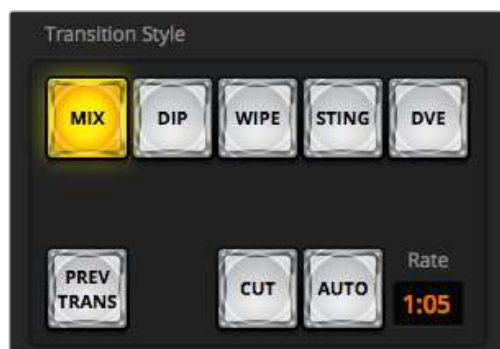
Le bouton de transition AUTO fait partie de la section Transition Control/Style de transition.
