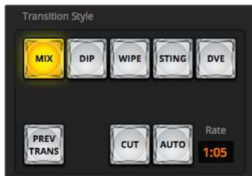
Le bouton de transition CUT fait partie de la section Transition Style
