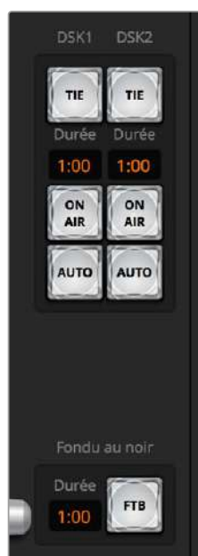
Incrustation en aval et fondu au noir
