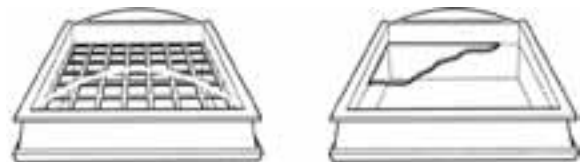
Bild 3-52: Lichtkuppel mit Gitter oder zusätzlicher einbruchhemmender Verglasung
