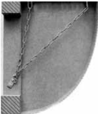
Bild 3-49: Befestigung im Mauerwerk beim Kunststofflichtschacht
