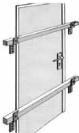
Bild 3-30: Tür mit Vorlegestangen
