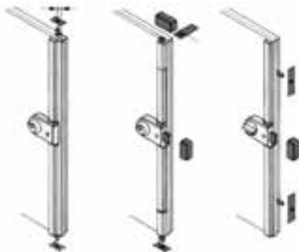
Bild 3-10: Aufsatzschlösser mit Mehrpunktverriegelung
