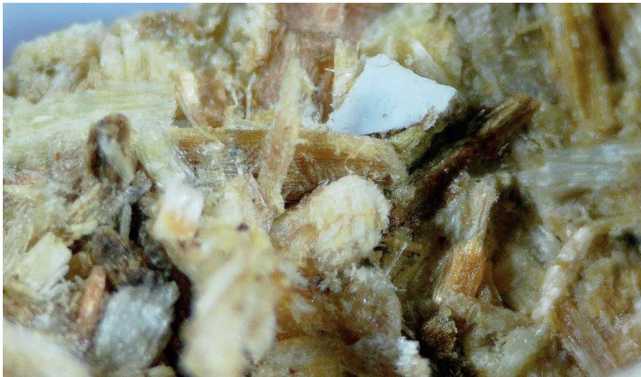
Figur 1: Återvunnet byggmaterial innehållande en stor mängd olika fragmenterade byggprodukter, flera uppenbart utan tillräcklig kontroll.
