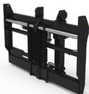
PIASTRA PORTAFORCHE A DOPPIA FUNZIONE DEL TIPO AD AGGANCIO CON TRASLATORE E POSIZIONATORE FORCHE SIMULTANEO E INDIPENDENTE
