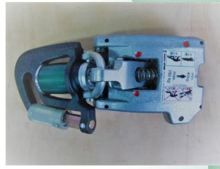
Bilder 1 - 2: Mitlaufendes Auffanggerät Typ: 0529.74 und Typ: 0529.7430
