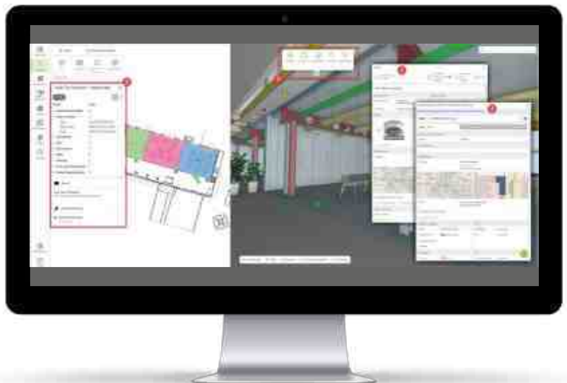
Abbildung 25: Navigation in einem 3D-Modell und Ausweisung objektbezogener wartungsrelevanter Eigenschaften, Dokumente und grafische Verortungen
