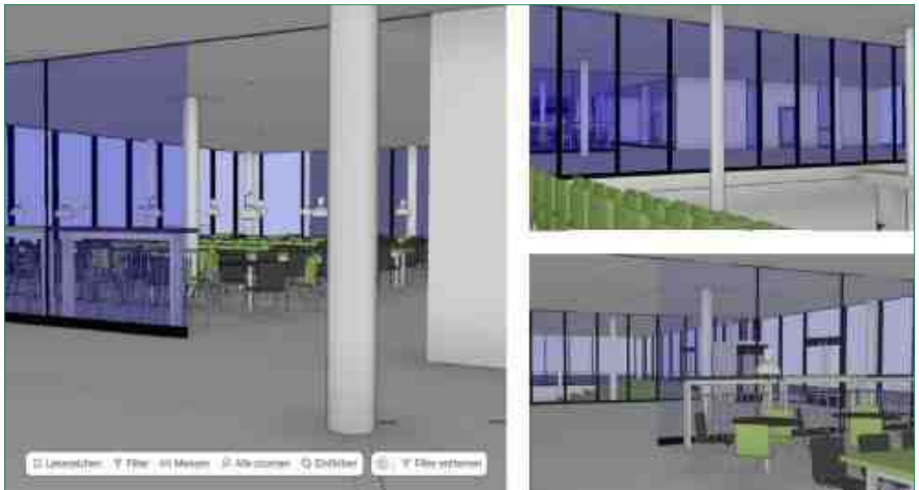
Abbildung 13: Exemplarische Darstellung eines BIM-Modells in einem 3D-Viewer zur visuellen Prüfung des Nachweises der Aufenthaltsqualitäten 27
