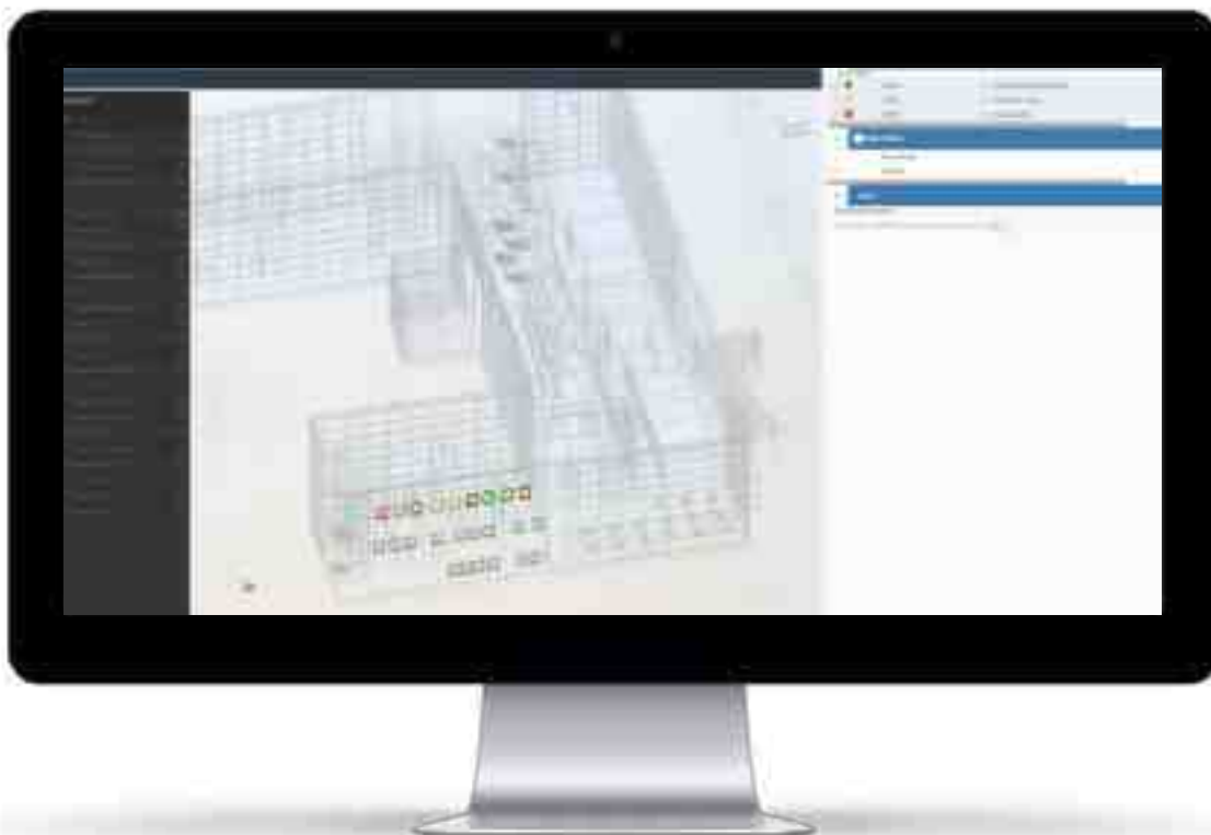
Abbildung 18: Nachverfolgung von Instandhaltungs- und Instandsetzungsmaßnahmen auf Basis eines Bauwerksinformationsmodells
