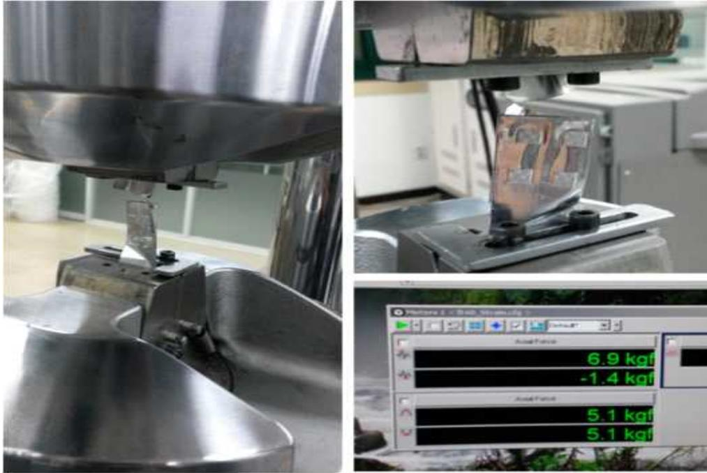
[그림 180] 초음파 금속 용접 성능시험 결과
