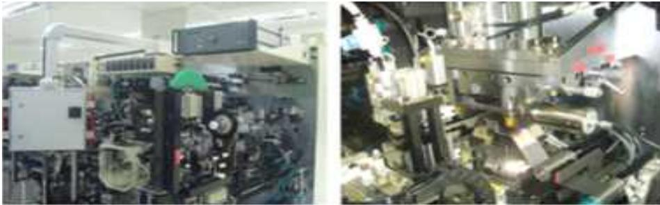
[그림 19] 초음파 용접 자동화 시스템
