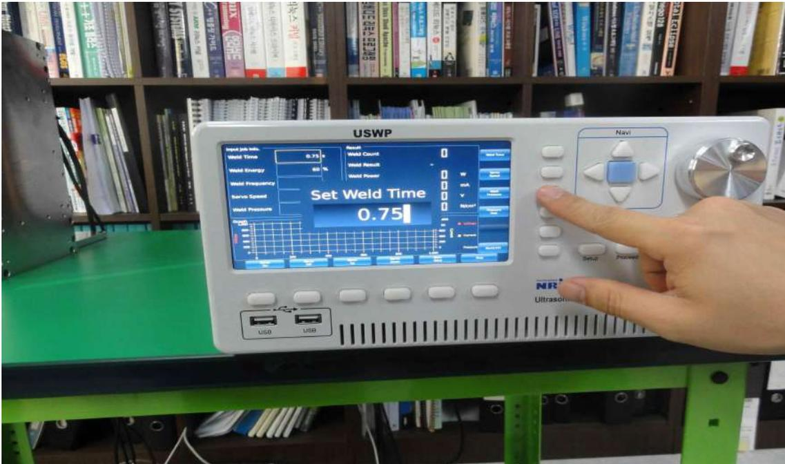
[그림 159] 초음파 용접용 Power Supply의 용접시간 설정 모습
