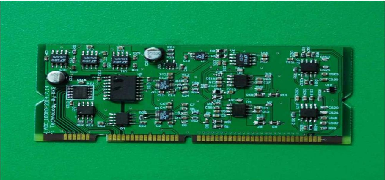
[그림 82] ADC 모듈 PCB 사진
