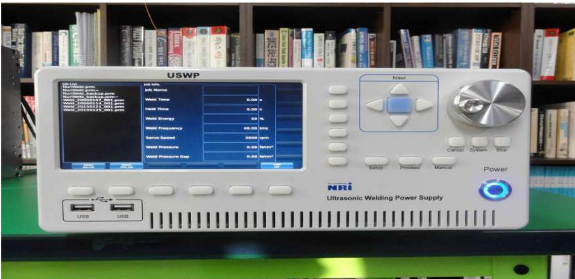
[그림 158] 초음파 용접용 Power Supply의 부팅된 모습
