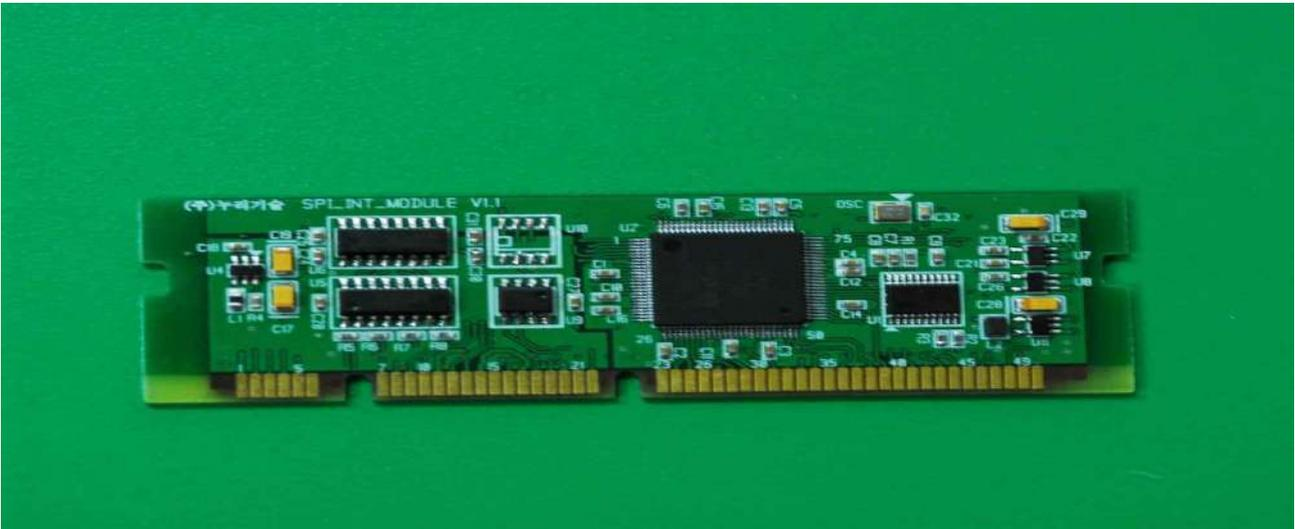
[그림 75] SPI 모듈 PCB 사진
