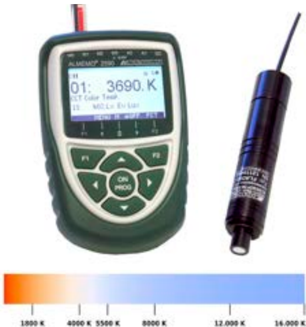
Farbtemperaturfühler mit ALMEMO® 2590-2 (Beispiel)
