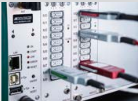
Anschlüsse für ALMEMO® Fühler und für Vernetzung (OLED Statusanzeige)
