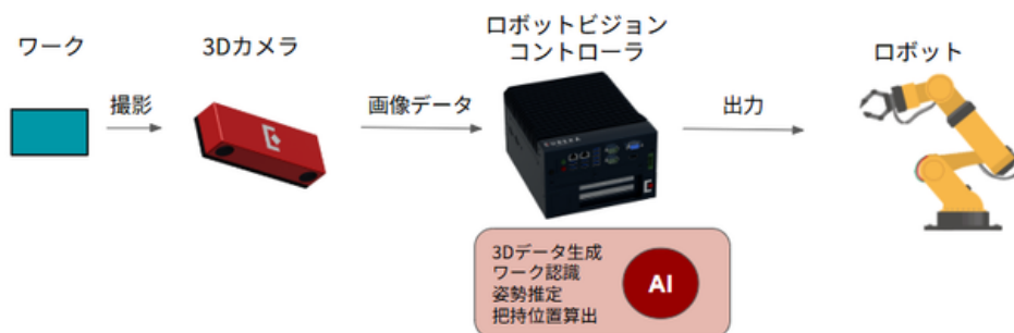
図2. ロボットビジョンシステムの処理フロー
