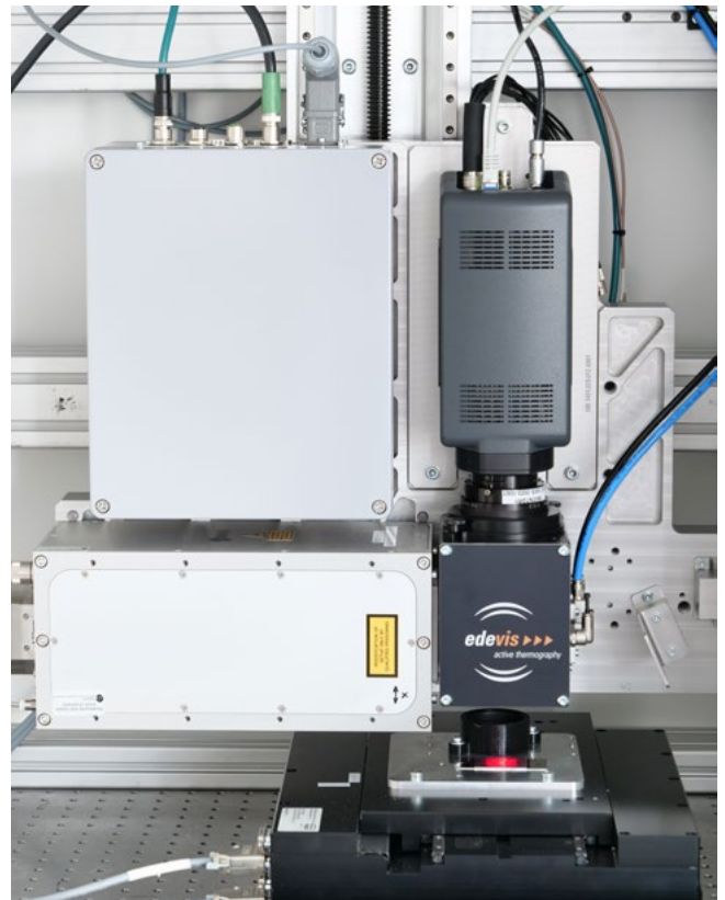
Abbildung 4: INSIGHT-L Prüfkopf mit aktivem Pilotlaser
