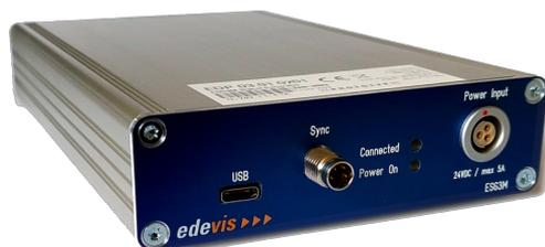
**Der EDEVIS Kompakt-Signalgenerator ESG** ist zentrales Bestandteil von Lockin-Thermografie Prüfsystemen. Er übernimmt über eine einheitliche Benutzerschnittstelle (EDEVIS Software DisplayIMG) die Ansteuerung aller eingesetzten Systemkomponenten (Leistungsquelle und Triggerung IR Kamera).
