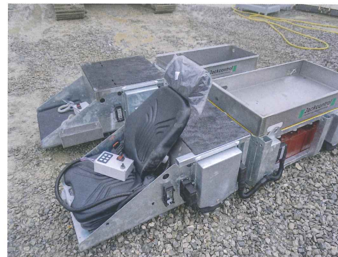
Abbildung 3: multifunktionelles, autarkes Tunnelfahrzeug «CT Rover» mit zwei Teilfahrzeugen
