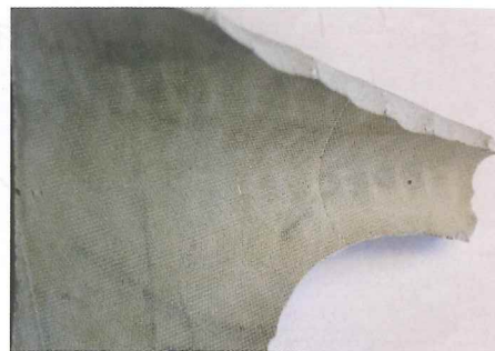
Abbildung 2: Ausschnitt eines Stücks ausgehärteter Zementsuspension, welche eine Hydraulische Fuge umschloss
