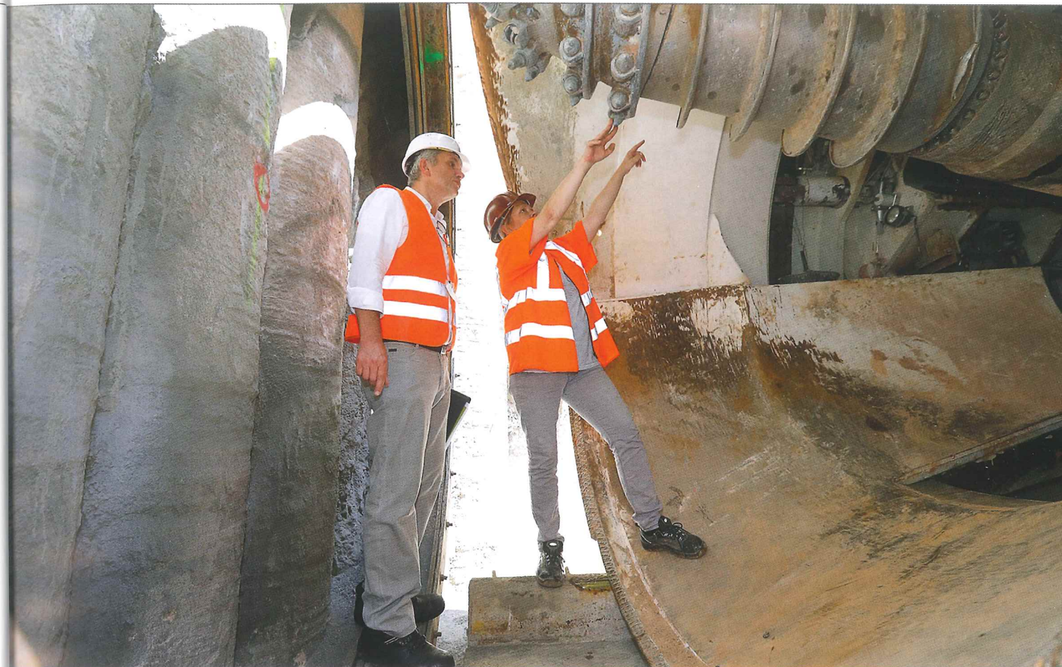
Miriam Liß inspiziert mit Dieter Walter die Abbauwerkzeuge der Vortriebsmaschine.
