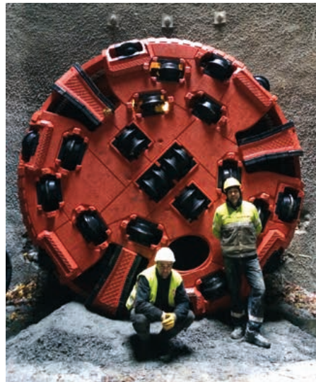
Da der Fels härter war als erwartet, wurde nach 200 Metern Vortrieb das Schneidrad gewechselt. | Foto: K-Borining
