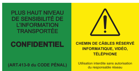
Étiquette de chemin de câbles
