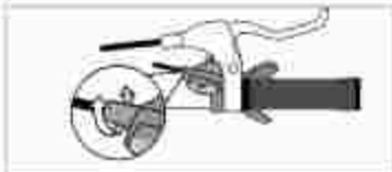
Fig. Vite tendicavo nella leva del cambio esempio
