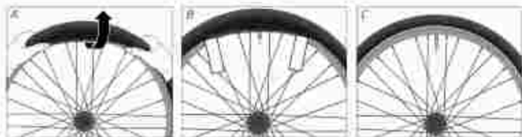
Fig. Montaggio pneumatico rigido a profilo ad innalzata
