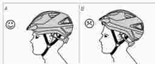
A) Helmen sidder (A) korrekt. B) sidder for langt tilbage (B) er forkert.
