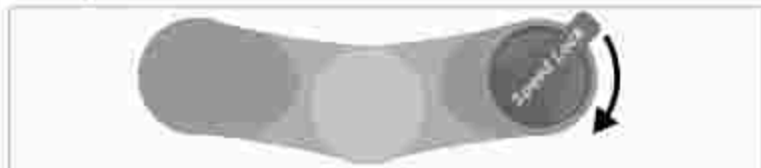
Fig. Manejo de la función Lock-Out en la horquilla de suspensión (visto desde arriba, ejemplo)
