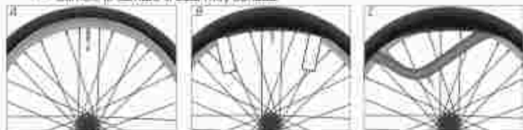
Fig. Desmontaje de los neumáticos radiales (ejemplo)
