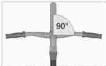
Fig. - Orientation adéquate du cintre (exemple)
