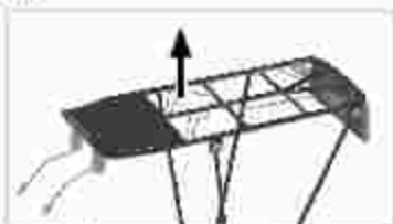
Fig. - Porte-bagages avec clapet à ressort (exemple)
