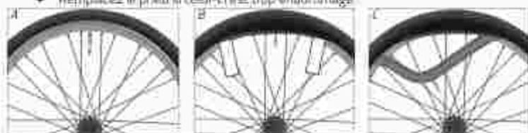
Fig. 14.11.5 Démontage d'un pneu à tringles rigides ou souples à l'aiguille
