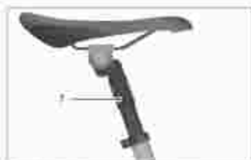
Fig. : Tige de selle suspendue ajustable 1 Suspension réglable
