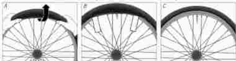
Fig. Monter un pneu à tringles rigides ou souples (sans chambre).
